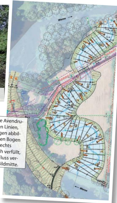
Rückbau der bestehenden Anlage sowie die Umgestaltung der Werse in ein sogenanntes Raugeinne mit 38 Steinriegeln und Becken. Die neue Fließstrecke wird rund 300 Meter lang, 15 bis 30 Meter breit und hebt die Flusssohle um über zwei Meter an. Fischarten können künftig durch Schlitzte in den Steinriegeln aufwärts wandern. Zur Verbesserung der ökologischen Qualität werden zudem Totholzelemente, Kieslinsen und eine standortgerechte Uferbegrünung eingebracht.
